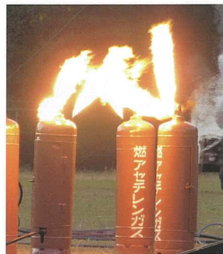
溶栓から噴出したアセチレンガスに着火した様子
