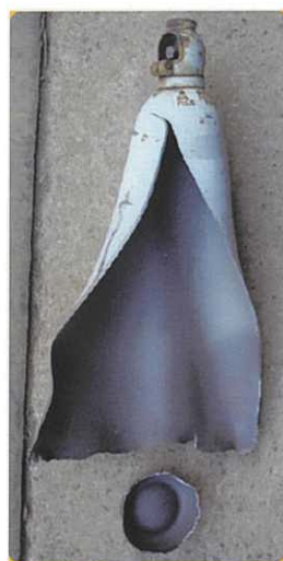
破裂した高圧ガス容器
